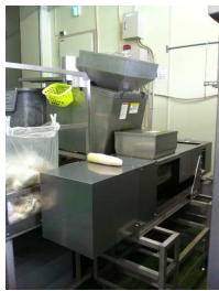
野菜残渣を破碎して脱水
