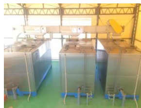
3台の生ごみ処理装置
